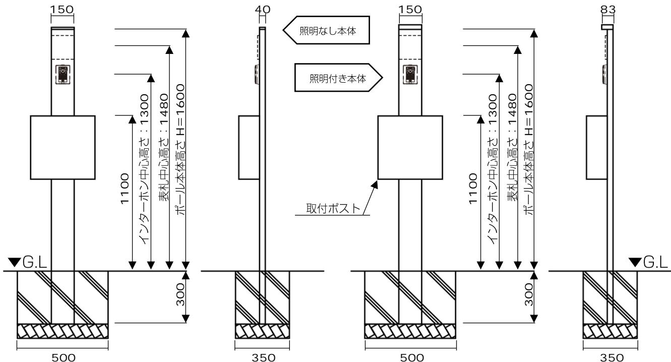
02：基礎穴を掘り、割栗石を敷き均して突き固めてください。
