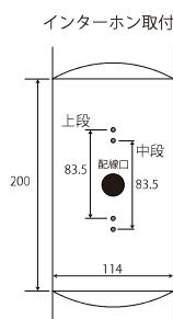
インターホン取付部には、スイッチボックス等と同じ規格の83.5mm ピッチで M4 サイズのネジ穴があります。上段と中段の 2箇所のネジ穴がありますので、お手元のインターホンに合わせて取付けてください。通常は中段のネジ穴で問題ありませんが、Panasonic VH556 など、下方からネジ止めの必要がある機種の場合は上段のネジ穴を使っていただくことで、インターホン下方にスペースができ、取付けが可能になります。防水処理等は取付けるインターホンの施工説明書に準拠してください。
